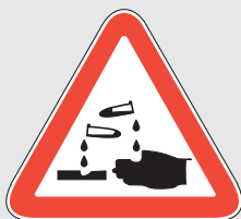
OPASNOST OD KOROZIJE
